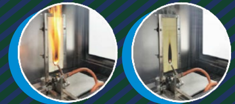
Elemento filtrante sin tratamiento anti llamas VS. Elemento filtrante con tratamiento anti-llamas
