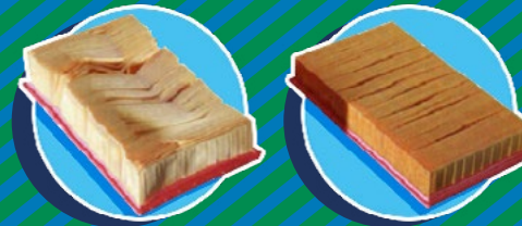
Filtro deformado por la humedad debido a una impregnación inadecuada VS. Filtro con una impregnación adecuada
