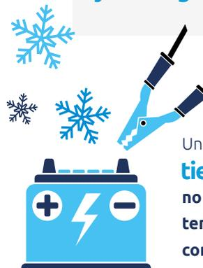
Una batería de baja calidad **tiene una vida más corta no responde ante bajas temperaturas y se descarga con facilidad** si el vehículo no se utiliza con frecuencia.
